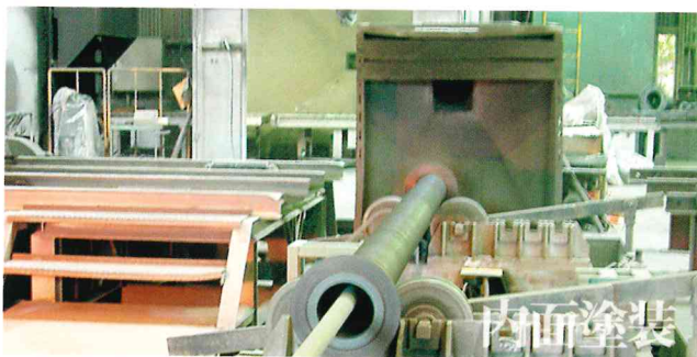
03-1 炉内で管を230℃に加熱し、自動吹きつけによってエポキシ樹脂粉体塗装を行います。
